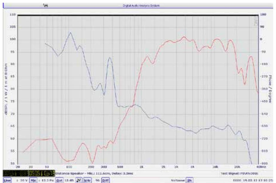
Die Diagramme zeigen oben SPL und akustische Phase eines typischen Mundorf-AMT, darunter SPL und akustische Phase eines Kompressionstreibers. Der Phasenverlauf des AMT ist im gesamten Übertragungsbereich und auch im Bereich der Übernahmefrequenz zum Mitteltöner hin, sehr gleichmäßig. Die Veränderung liegt nahe oder unter Wahrnehmungsgrenze von 15° pro Oktave.
