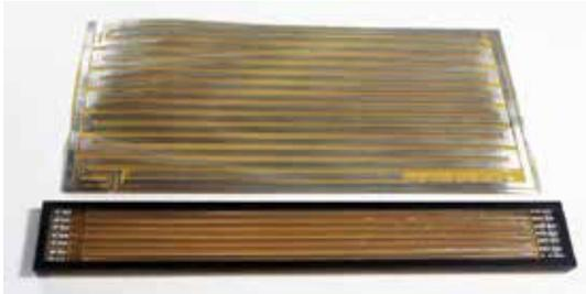
Ein gewichtiger Vorteil der gefalteten Membrane ist die große Membranoberfläche, die auf vergleichsweise kleinem Raum untergebracht werden kann. Das Foto zeigt das Verhältnis von gefalteter zu ungefalteter Membran. Die Membranoberfläche ist um ein Vielfaches größer als z.B. die Membran in einem Druckkammertreiber oder einer herkömmlichen Kalotte. Aber auch die plane Fläche eines Magnetostaten oder Bändchen-Hochtöner mit gleich großem Schallaustritt ist deutlich kleiner.
